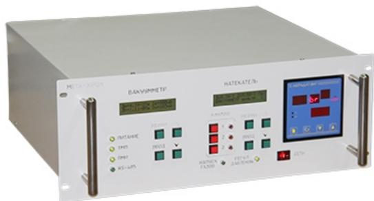
Прибор работает в непрерывном диапазоне значений давления без переключения пределов измерений от 100 до  $10^{-5}$  Па (0,8- $10^{-7}$  мм. рт. ст.).
