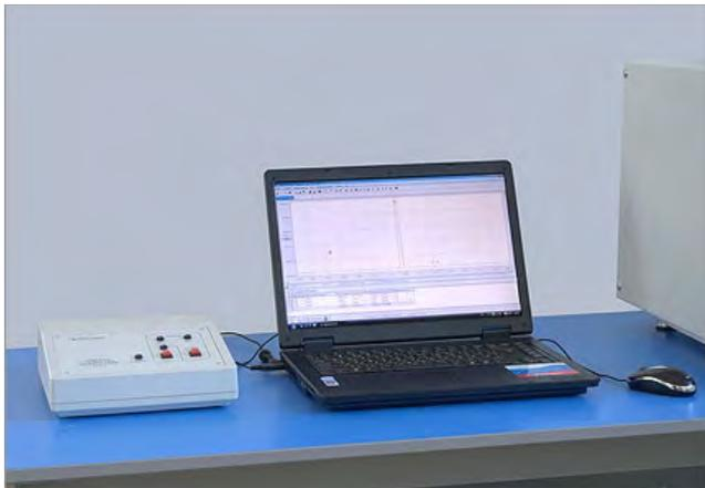
В состав программно-аппаратного комплекса входит электронный блок воспроизведения аналоговых сигналов и компьютерная программа формирования и записи стандартных хроматограмм.
