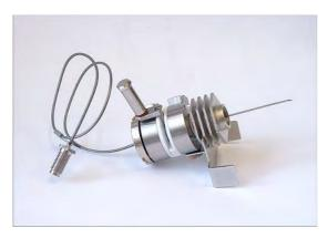
Кран укомплектован штуцером с фильтром на входе для подключения к пробоотборнику (типа ПГО по требованию потребителя), дросселем для регулирования потока жидкости, трубкой для соединения газовой схемы. КДСГ по желанию потребителя может быть автоматизирован.
