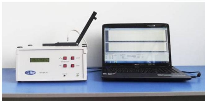
В состав прибора «Гейзер - 2А» входят термостат, оптический датчик, блок управления термостатом (контроллер), персональный компьютер. Измерение задержки времени воспламенения веществ осуществляется таймером, управляемым как пользователем, так и автоматически в зависимости от режима работы.
